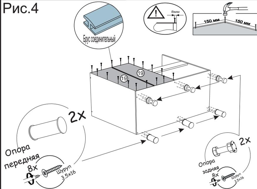
Примечание: При установке кухонного гарнитура в комплектации с цоколем спереди использовать черные опоры
